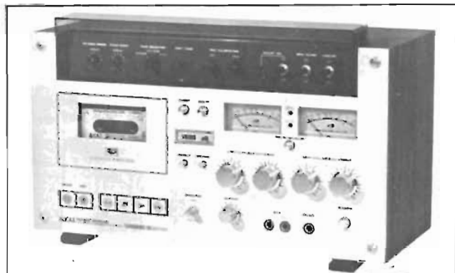
AKAI: Sistema di lettura per cassette con testine in cristalli di ferrite GXC 570 D. Ingressi separati anche per il mixaggio incrociato. Dolby incorporabile. Polycolor - Via dei Gracchi, 6/10 - Milano
