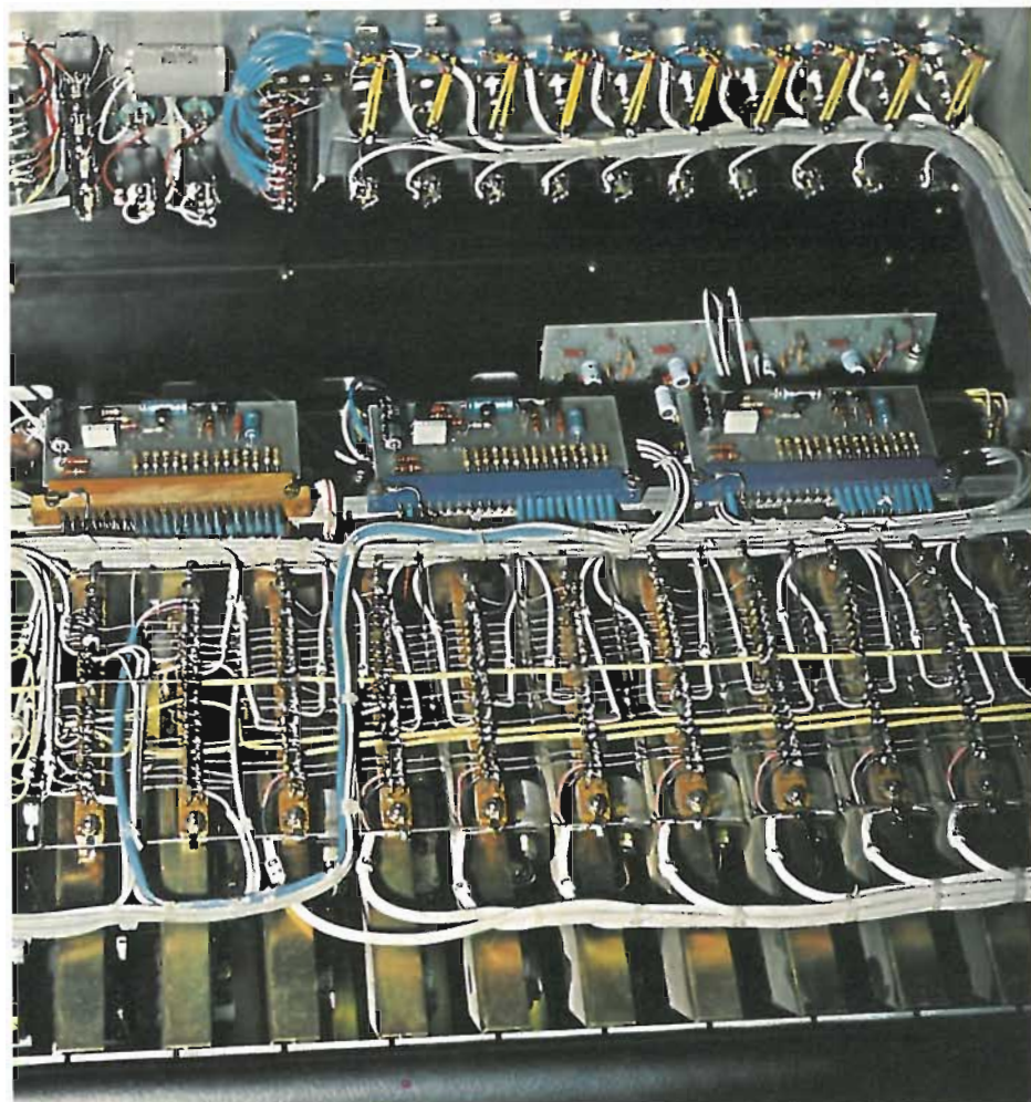
Mixer AKG 12 ingressi e 4 uscite (prezzo attorno ai 2 milioni). Il sistema è modulare (ogni canale è costituito da un modulo sfilabile dallo chassis), le barre di programma, d'eco, di cuffia e di alimentazione si distinguono nettamente; esse sono collegate allo zoccolo di connessione dei moduli in modo uguale per tutti i canali. Il risultato è un tipo di costruzione molto pulita e razionale. Si distinguono (al centro) i circuiti stampati dei quattro amplificatori di uscita e le connessioni con gli ingressi e le uscite del mixer (a destra).
